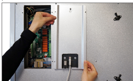
4. Irroita suoja ja ripusta se reiän viereen.
